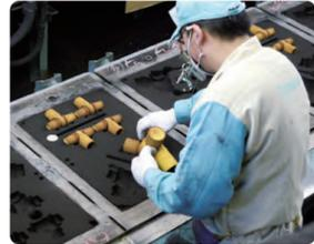
◀砂で鑄物の型を取り、中に空気を流すための砂を入れていく作業です
