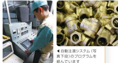
◀自動注湯システム(写真下段)のプログラムを組みんでいます
