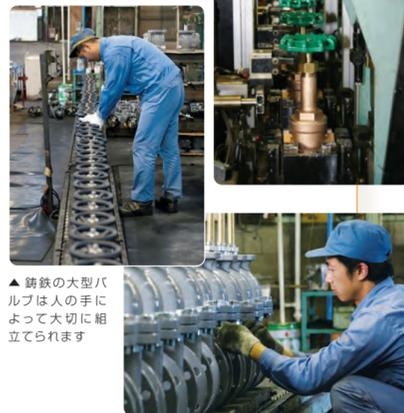
▲鑄鉄の大型バルブは人の手によって大切に組立てられます
