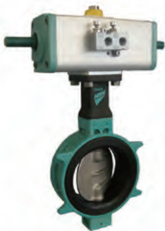
・EP ポジショナー搭載 ・電磁弁（連続通電仕様）搭載 ↓ 非通電時バルブ閉
